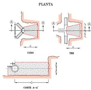
**DETALLE DE ANCLAJES PARA REDUCTORES**
